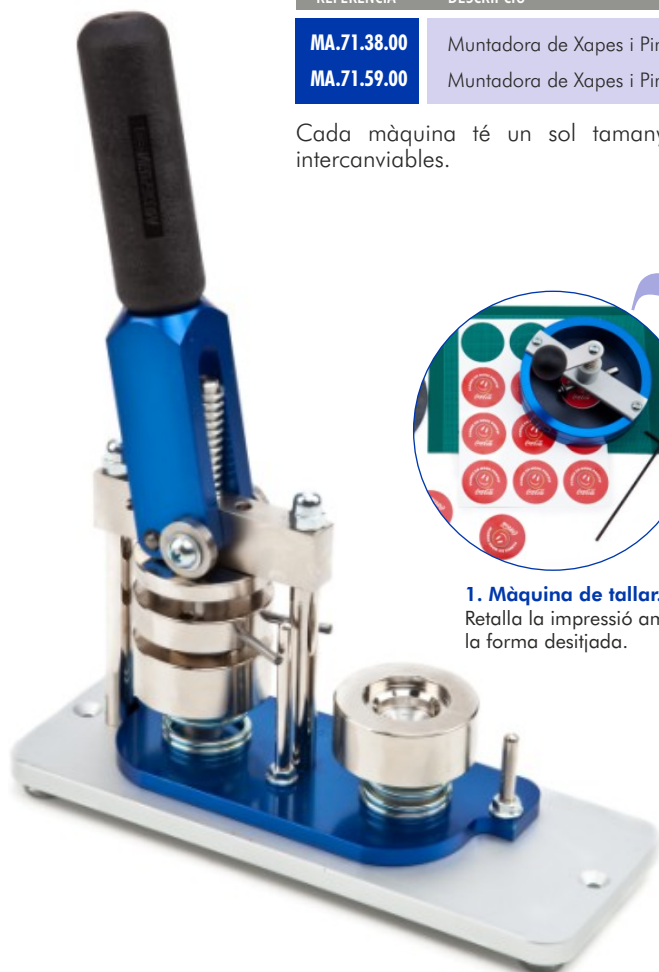
2. Màquina de muntar. Munta/inserta la impressió en la xapa.
