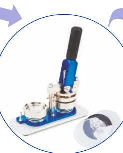
2. Màquina de muntar. Munta/inserta la impressió en la xapa.
